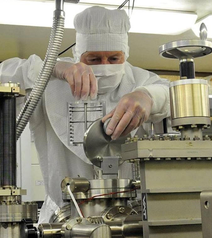
Proben ohne Unterbrechung des Vakuums in die Wachstumskammer
