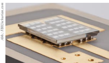
Am FBH realisierter Prototyp eines GaN-Flip-Chip-Leistungstransistors
