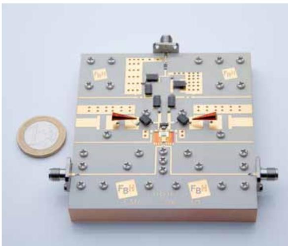
Abb. 2: Zwei verschiedene Topologien des Klasse-S-Verstärkers für 450 MHz, die am FBH realisiert wurden.
