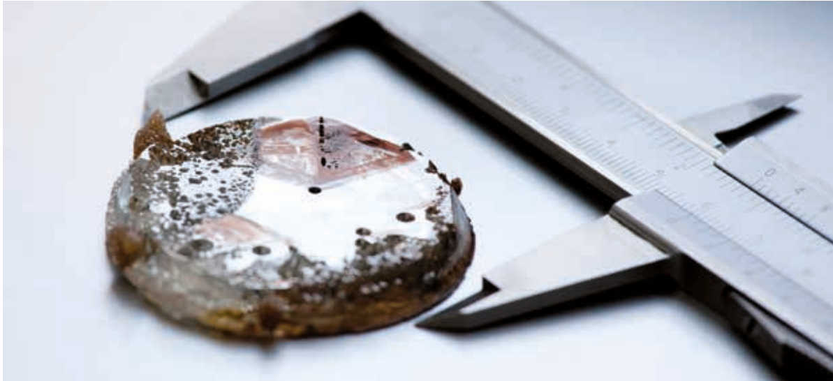
Kristallscheibe, die mit dem Verfahren der Hydrid-Gasphasenepitaxie hergestellt wurde.
