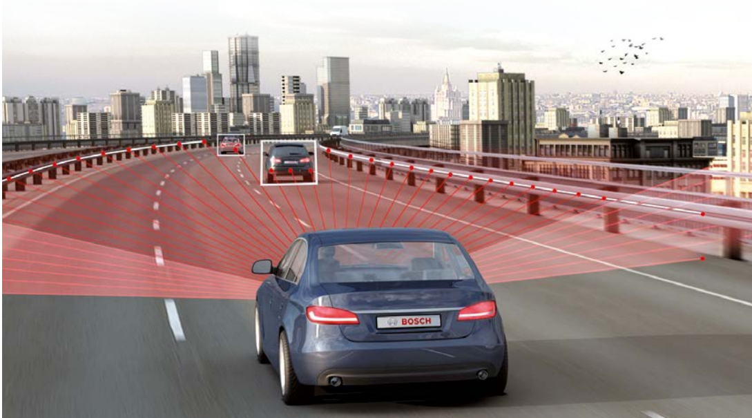
Flashlidar-Systeme sind zusammen mit Sensoren wie Kameras und Radar ein erster Schritt zur 3D-Umgebungserfassung, Flashlidar systems combined with other sensors such as cameras and radar are a first step towards 3D environment perception.
